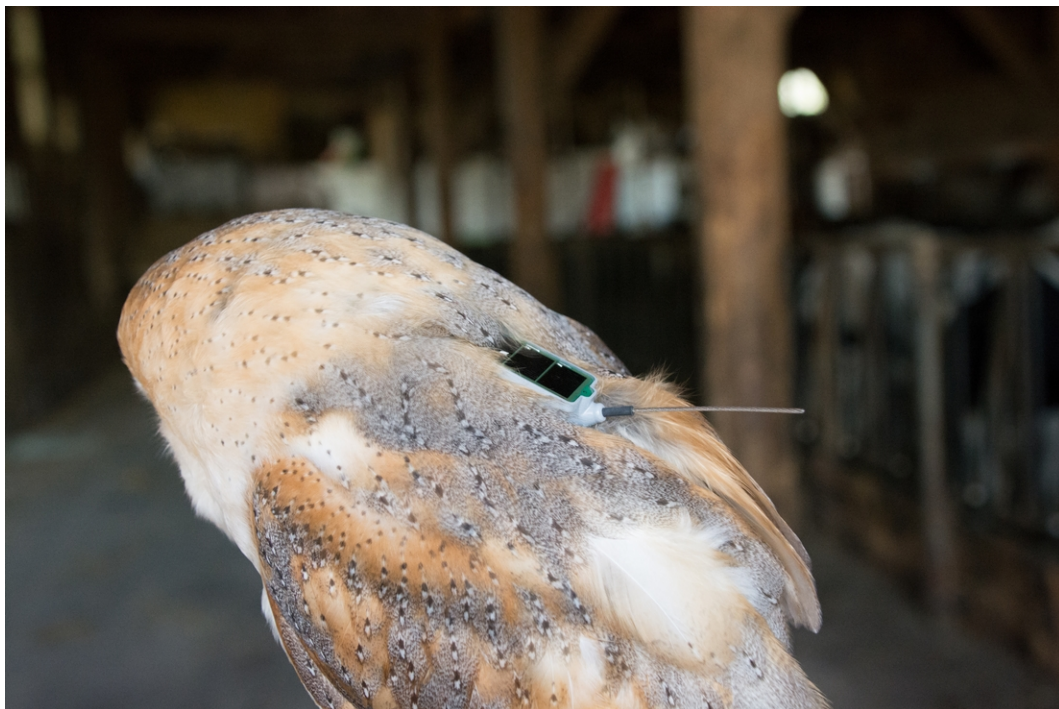
Figuur 3. Adult met GPS logger. Antenne en zonnecel zijn hier nog goed te zien. Na loslaten wordt de logger meestal bedekt door de dekveren.
